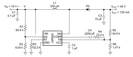
Figure 8-7. Boost Schematc
