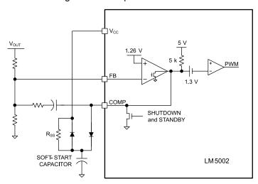
Figure 8-4. Soft-Start Circuit
