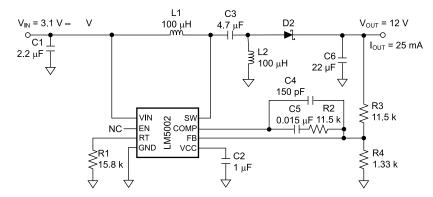
Figure 8-9. 12-V SEPIC Schematic
