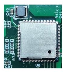
Figure 615: RTL8821CS WiFi/BT Module
