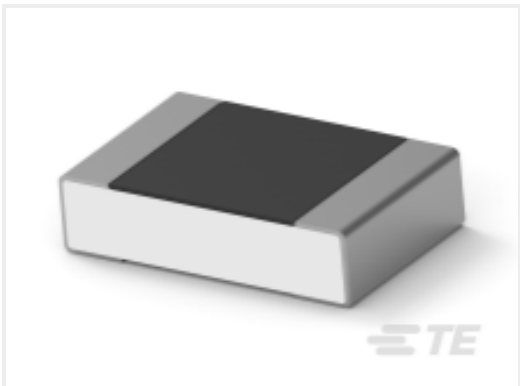
TE Part #4-2176376-6 RQ 0805 36K5 0.1% 10PPM 1K RL
